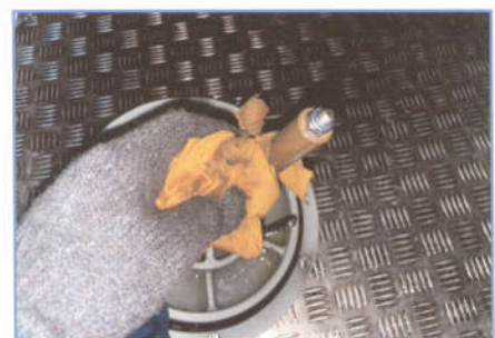
MHC 01 วันที่ 27 พฤศจิกายน 2568 ทำความสะอาดแม่เหล็กใน Return Filter
