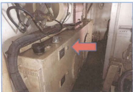
MHC 01 วันที่ 27 พฤศจิกายน 2568 ตรวจเช็คน้ำมัน Hydraulic Oil Tank
