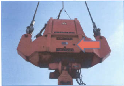
MHC 01 วันที่ 27 พฤศจิกายน 2568 ตรวจเช็คน้ำมันไฮดรอลิกมอเตอร์ Rotator
