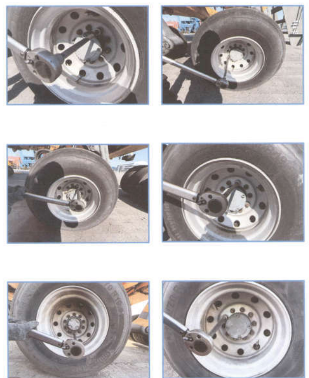
MHC 01 วันที่ 27 พฤศจิกายน 2568 ตรวจสอบความหนาแน่นของสกรูระบบ Traveling
